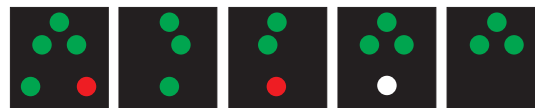
DRAGAMINE PRUA IN MOVIMENTO LATO DRIFFO IN MOVIMENTO LATO SINISTRO IN MOVIMENTO POPPA IN MOVIMENTO FERMA
