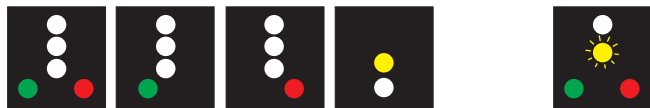
RIMORCHIATORI (LUNGH. TOTALE RIMORCHIO OLTRE A m 200) PRUA IN MOVIMENTO LATO DRIFFO IN MOVIMENTO LATO SINISTRO IN MOVIMENTO POPPA IN MOVIMENTO HOVERCRAFT PRUA IN MOVIMENTO
