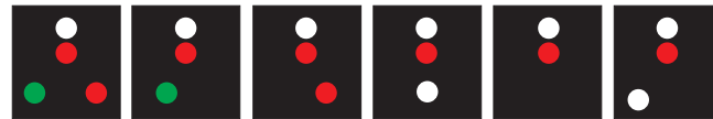
NAVE PILOTA PRUA IN MOVIMENTO LATO DRIFFO IN MOVIMENTO LATO SINISTRO IN MOVIMENTO POPPA IN MOVIMENTO FERMA OGNI LATO ALL'ANCORA INF. m 50
