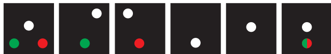
NAVE PROPULSIONE MECCANICA INFERIORE. m 50 PRUA IN MOVIMENTO LATO DRIFFO IN MOVIMENTO LATO SINISTRO IN MOVIMENTO POPPA IN MOVIMENTO ALL'ANCORA OGNI LATO INFERIORE. m 20 PRUA ≤ m 20 IN MOVIMENTO
