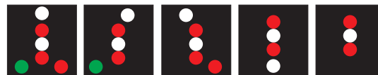
NAVE CON MANOVRABILITÀ LIMITATA PRUA IN MOVIMENTO LATO DRIFFO IN MOVIMENTO LATO SINISTRO IN MOVIMENTO POPPA IN MOVIMENTO FERMA
